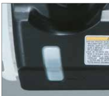
Jednoduchá kontrola množství oleje v nádrži
