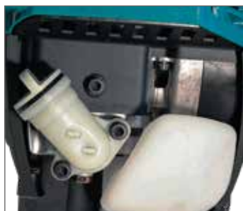
Systém mazání umožňuje práci v jakémkoli úhlu
