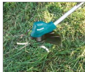
Zpětný chod pro očištění nástroje
